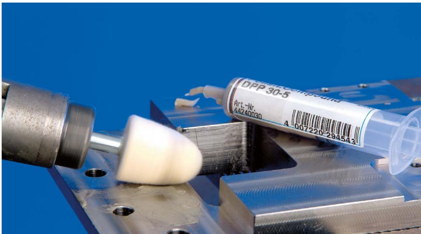
Los discos y lentes de fieltro normalmente se utilizan para pulir con el contorno de la herramienta.
