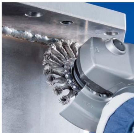
Carda agresiva adecuada para trabajos pesados en la construcción de metal como descascarillar, eliminar herrumbre, limpiar cordones de soldadura y eliminar restos de pegamento.
