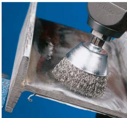
Uso universal para limpiar, desbarbar, alisar, descascarillar y eliminar corrosión y lacas. Su uso frontal permite utilizar toda la superficie del alambre lo que la hace adecuada para superficies grandes y planas de fácil acceso.
