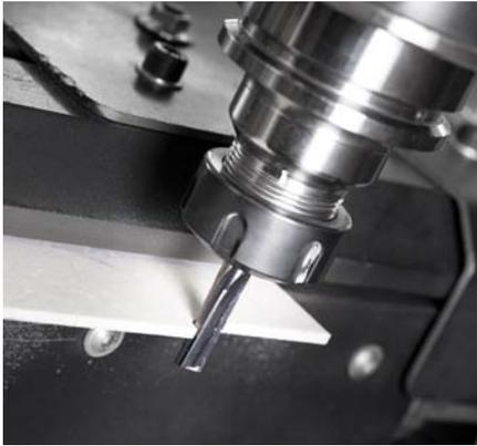
Fresa forma cilíndrica.
