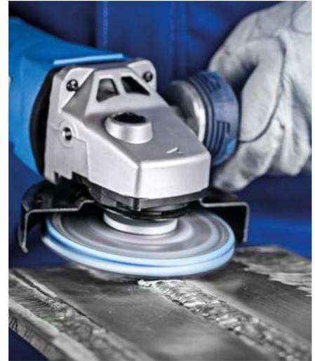
**PFERDERGONOMICS®** recomienda el disco de fresado High Speed **ALUMASTER®** como herramienta innovadora para el mecanizado de aluminio, ya que no genera polvo explosivo ni peligroso para la salud.
