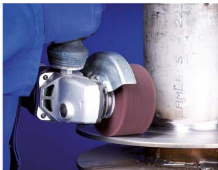
Láminas de vellón dispuestas radialmente. Gracias a las compactas láminas la herramienta tiene una larga vida útil.
