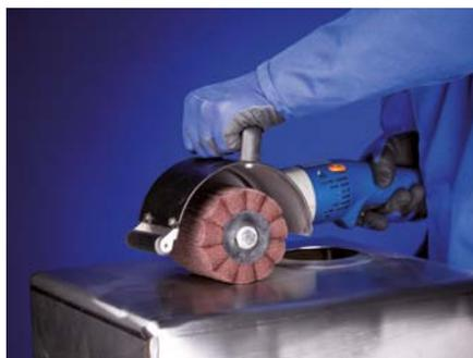
Láminas de vellón muy onduladas dispuestas axialmente alrededor de un núcleo.
